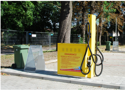
Stanowisko odkurzania - odkurzacz standardowy, trzepaczka
